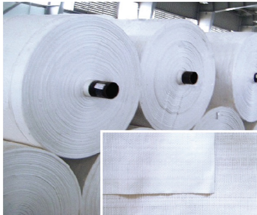
VẢI ĐỊA KỸ THUẬT
